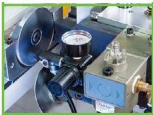
Подача жидкости в зону резания
