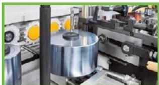
Узел предварительной обрезки (Состоит из двух узлов)
