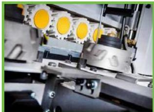
Узел предварительного фрезерования
