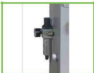
Подготовка сжатого воздуха
