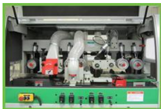
Дополнительная панель управления
