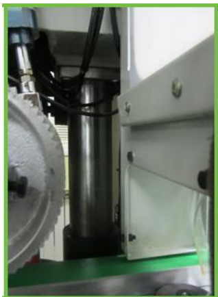
Параллельный упор с механизмом точной настройки
