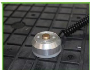
Датчик измерения и калибровки длины инструмента
