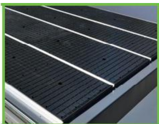
Вакуумный рабочий стол с «т» - пазами для механического крепления
