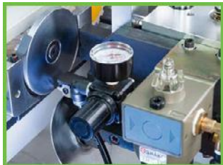
Подача жидкости в зону резания
