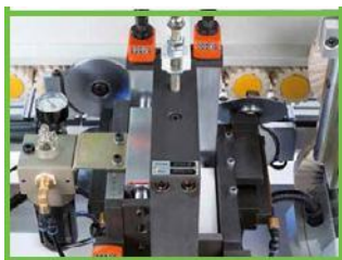
Узел радиусной цикли
