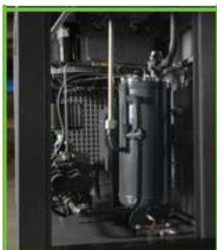
Трехступенчатая система сепарации
